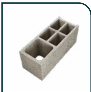
BLOC D'ANGLE - CHAÎNAGE VERTICAL Dimensions : 50 x 20 x 20 cm Poids / pièce : 19 kg Poids / palette : 1 350 kg (70 blocs par palette)
