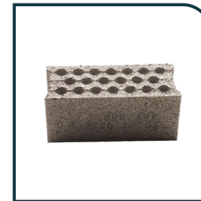
BLOC SEMI-PLEIN Dimensions : 50 x 20 x 20 cm ( 27 kg ) ou 50 x 15 x 20 cm ( 26 kg )
